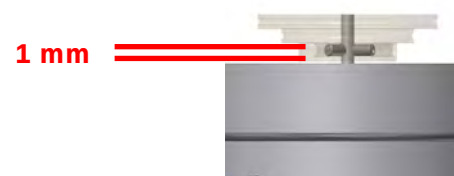
Abb. 12: Befestigen des Antriebsrades
