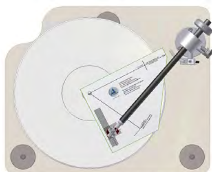
Abb. 10: Absenken des Tonabnehmers auf der Schablone
