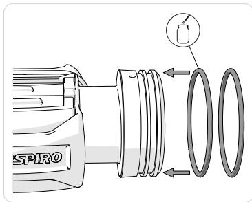
10. Sett den nye filtertilkoblingen på adapteret og fest de to skruene (Torx T9) med et strammemoment på 0,5 Nm.
