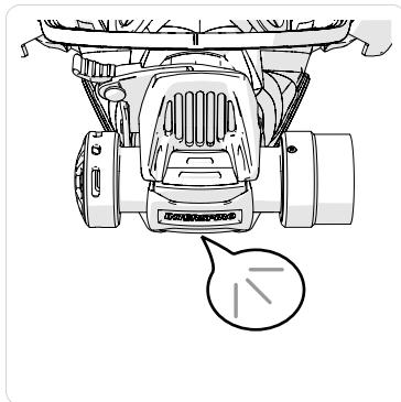
2. Forsikre deg om at adapter er montert slik at teksten INTERSPIRO er lesbar fra forsiden av masken.
