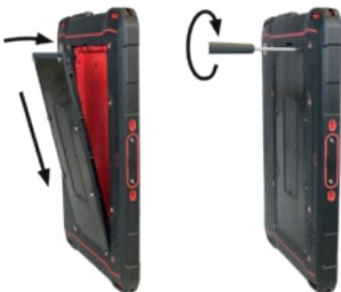
» Placera batteriet i batteriutrymmet enligt bild. Se till att de guldfärgade kontakerna på batteriet och enheten är vända mot varandra.
