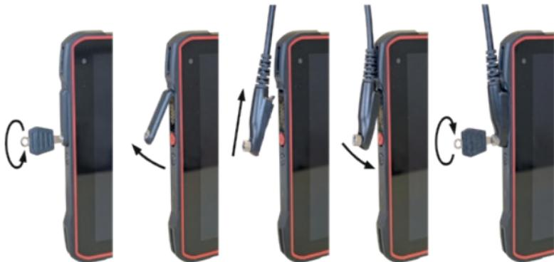
» Ослабьте винт на крышке интерфейса 16-pin ISM с помощью входящей в комплект отвертки. Снимите крышку, как показано на рисунке.
