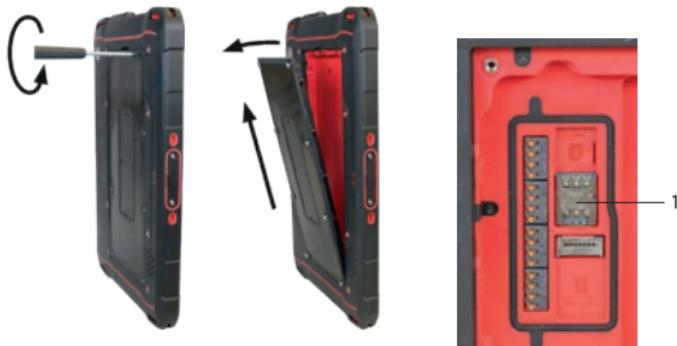
» 付属のTorxドライバーで、バッテリーのネジを締めます。
