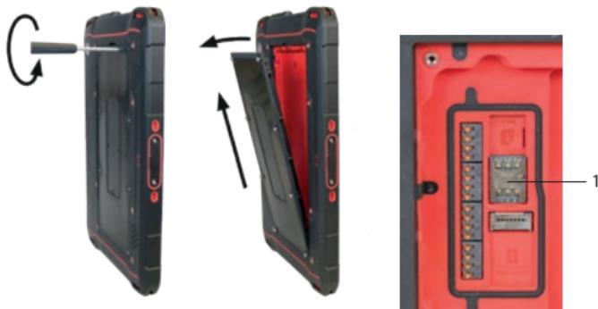
» Löysennä akkukotelon ruuvit toimitukseen sisältyvällä Torx-ruuvitallalla.
