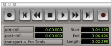
Das Transport-Fenster mit angezeigten Start- und End-Feldern
