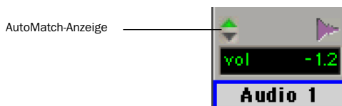
Dreieckige AutoMatch-Anzeigen in einem Kanalzug
