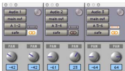
Gekoppelt (links), ungekoppelt (Mitte) und umgekehrte Koppelung vorne (rechts) in den Output-Fenstern
