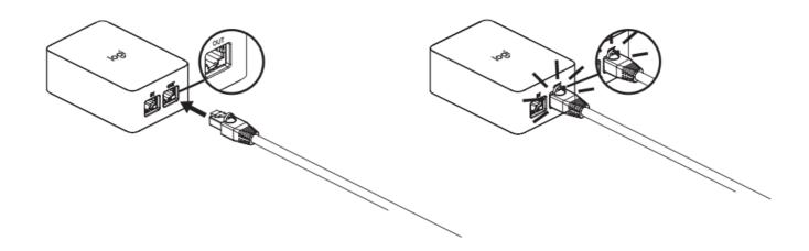
STEP 5: CONNECT THE POWER INJECTOR TO A POWER OUTLET
