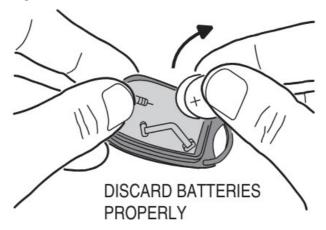
4. SLIDE IN TWO NEW TYPE 2016 BATTERIES BE SURE BOTH PLUS (+) SIDES ARE FACING AWAY FROM THE CIRCUIT BOARD
