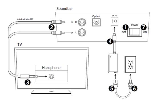
**DUAL RCA TO DUAL RCA ANALOG CONNECTION**
