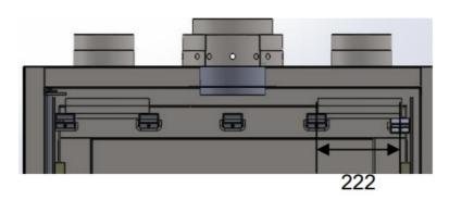
4. BAFFLE PLATE SIDE OF 222 MM SHOULD EXTEND FROM SIDE TO SIDE,
