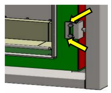
2. MARK THE POSITION OF THE ADJUSTMENT ANGLE ON THE FIREBOX. IT IS CRITICAL TO PUT THE ADJUSTMENT ANGLE AT THE SAME SPOT. SO THAT THE DOOR WILL LOCK PROPERLY.
