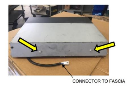
6. USE A FLAT SURFACE AND LAY THE FAN CASSETTE UPSIDE DOWN. REMOVE THE 2 SCREWS HOLDING THE FAN ASSEMBLY. THE FAN SHOULD NOW BE FREE. REPLACE THE FAN AS REQUIRED IN THE ORIGINAL POSITION INSTALLATION IS JUST THE REVERSAL OF THE STEPS OUTLINED
