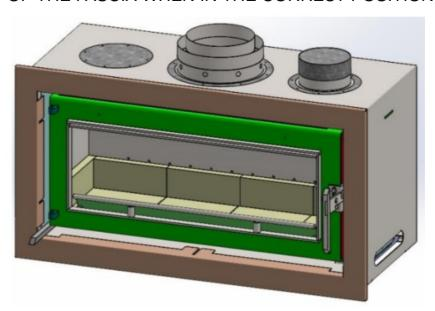
4. SLIDE FASCIA INTO THE REQUIRED POSITION THEN HAND TIGHTEN THE SCREWS AS REQUIRED OR USE AN APPROPRIATE ALLEN KEY OR PLIERS. USE A TOUCH UP PAINT ON THE SCREW HEADS AS REQUIRED.
