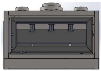
6. SLIDE THE BAFFLE PLATES ATOP THE OTHER 2 BAFFLE PLATES INTO THE MIDDLE POSITION AS SHOWN. LEAVE GAP OF 1-2 MM IN BETWEEN PLATES. THE GAPS SHOULD BE ROUGHLY IN THE MIDDLE OF THE AIR TUBES. UNIT IS NOW READY FOR USE.
