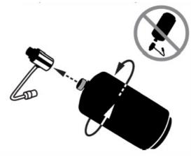
4. CONNECT AND SECURE FUEL CYLINDER TO REGULATOR IN UPRIGHT POSITION
