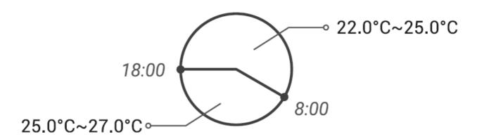
Temperature Control Instruction in the Timer Mode (TS1, DS1, TR=1, TS2, DS2, TAH, TAM, TBH, TBM, CTH, CTM)
