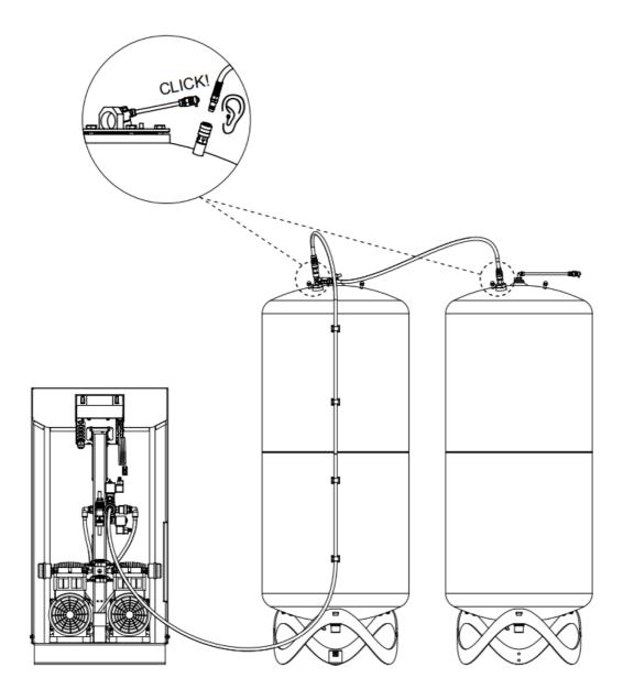
1x 230V/50/60 Hz C.1: 10A / 3 x 1,0 mm<sup>2</sup> C.2: 16A / 3 x 1,5 mm<sup>2</sup>
