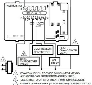
5-WIRE HEAT/COOL WITH DAMPER (JUMPER INTACT)
