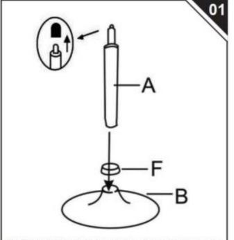
EN: The hydraulic cylinder has a cap on the top of it that must be removed prior toassembly FR: Le cylindre hydraulique a un bouchon sur le dessus qui doit être retiré avant le montage.
