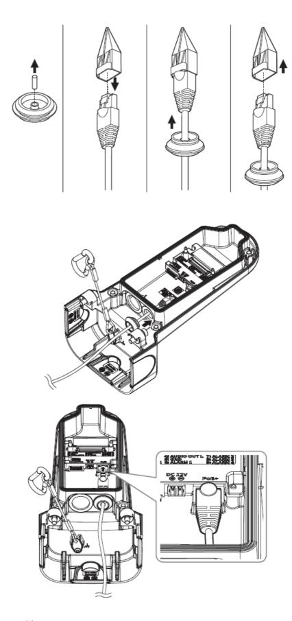
• Installing audio/alarm cables
