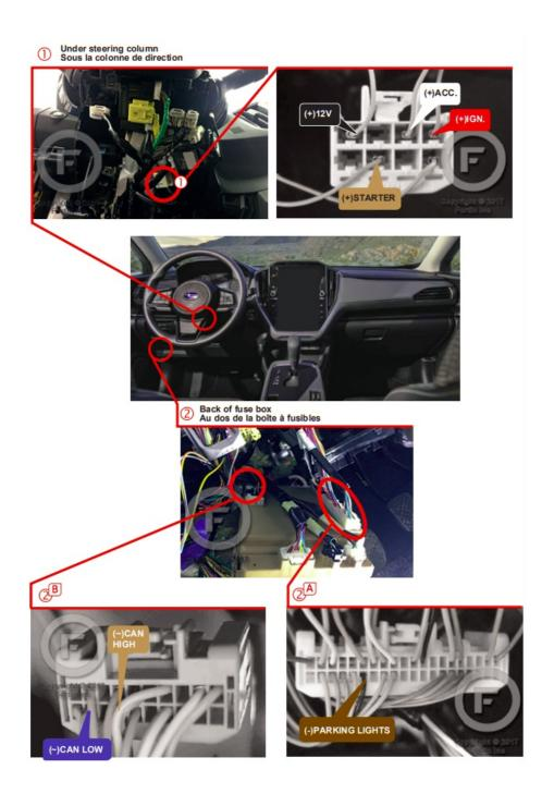
**AUTOMATIC TRANSMISSION WIRING CONNECTION**
