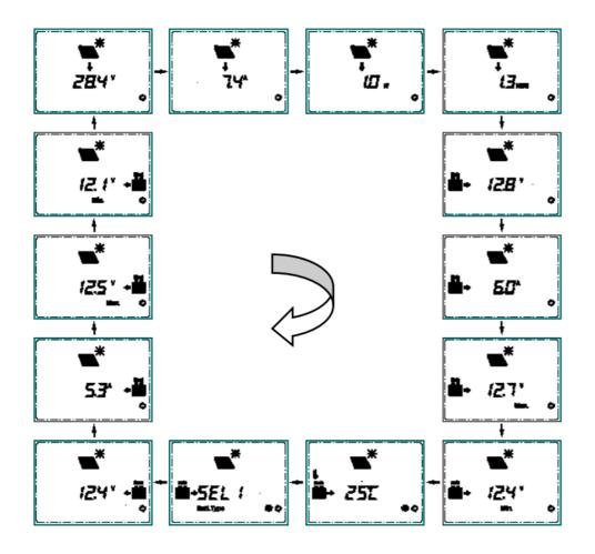
Echo Loop: PV voltage ——PV current ——PV power——Battery power——BATT1 voltage——BATT1 current ——Max. BATT1 voltage——Min.BATT1 voltage——BATT1 battery type——BATT2 voltage——BATT2 current——Max. BATT1 voltage——Min.BATT2 voltage——PV voltage
