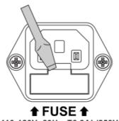
110-120V~60Hz: T6.3AL/250V 220-240V~50Hz: T3.15AL/250V
