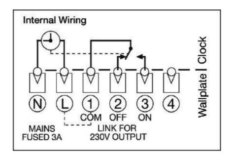
ALWAYS SWITCH OFF THE MAINS BEFORE REMOVING THE UNIVERSAL TIMESWITCH – AND NEVER FIT IT TO A LIVE WALL-PLATE!
