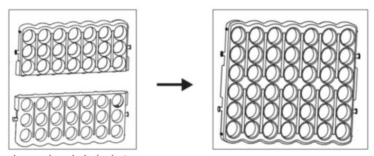
Conecte los dos paneles principales juntos.
