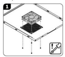
• Install the rear fan (120mm fan x 1)
