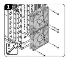
• Install the top fan (120mm fan x 2)
