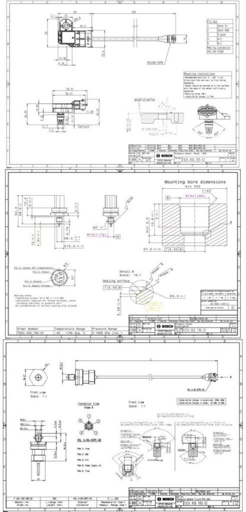
Kabelbaumstecker: RB-Kompaktstecker A 928 000 453, 3-polig, Kodierung 1, 0.5-1.0mm²
