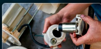
Test de la pompe à carburant
