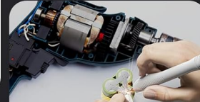
電動工具用バッテリーパックの 修理と組立
