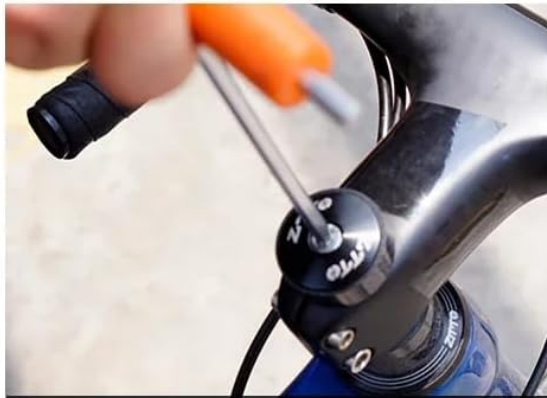
Step1 Remove the stem top cap
