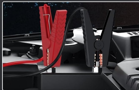
PHASE 2 Verbinden Sie die Klemmen mit dem Starter der Autobatterie
