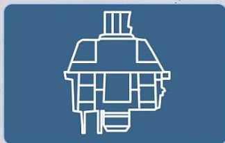
CreamMint Linear Switch (45gf, 2.0-3.6mm)
