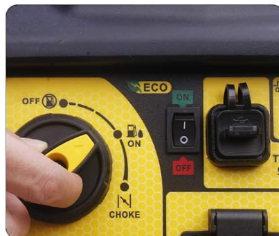
8 Lorsque le moteur démarre, placez l'interrupteur 3-en-1 en position « ON ».
