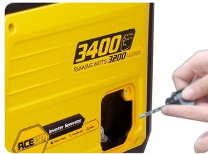
2 Vérifier le niveau d'huile pour s'assurer qu'il se situe dans la plage de fonctionnement sûre.
