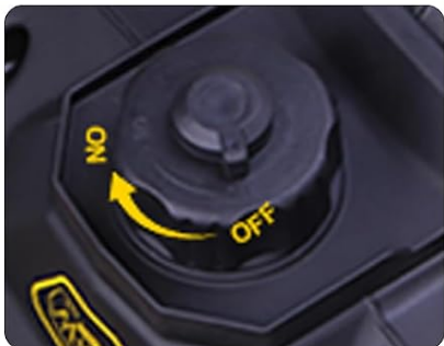
4 Activez le bouton de mise à l'air libre du réservoir de carburant.
