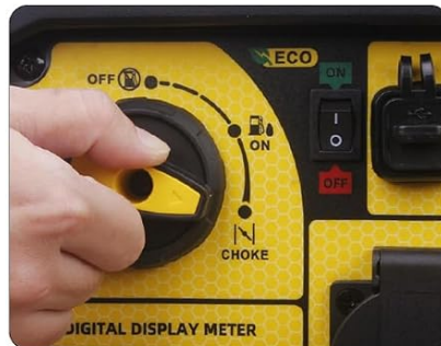
5 Placez le commutateur 3-en-1 en position « CHOKE ».
