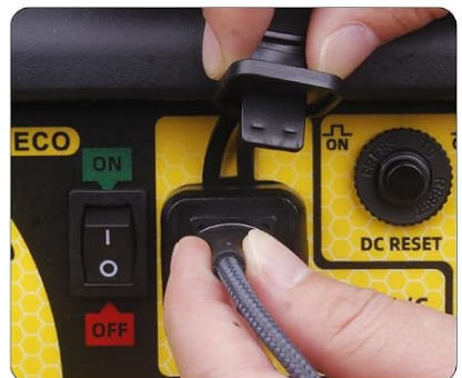
9 Laissez le moteur chauffer pendant 3 à 5 minutes, puis branchez les prises électriques.
