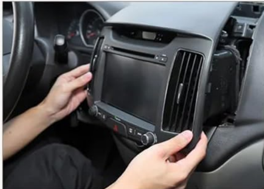
1. 装飾パネルを取り外し、出荷CDプレーヤーを取り出し、電源ケーブルを抜く。
