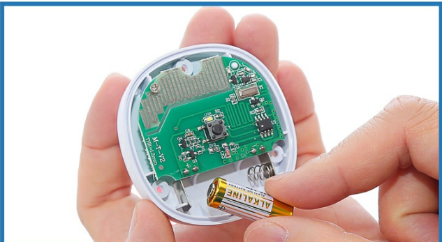
STEP2: 古い電池を取り外し、新しい電池と交換します。
