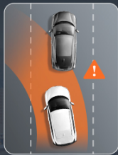
Avviso di superamento della corsia
