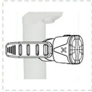
シートポストの取付指示図 ゴムバンドとシートポストブラケット を使用します。
