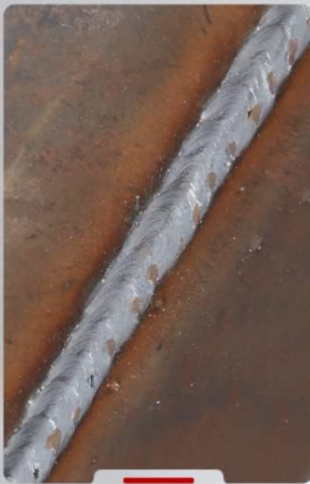
CO 2 MIG Welding
