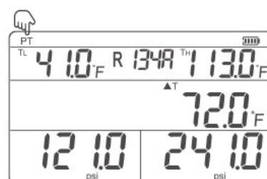
Figuur 3. Interfacediagram voor de submodus temperatuurverschil
