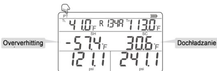
Afbeelding 2. Schema van de module interface oververhitting en onderkoeling
