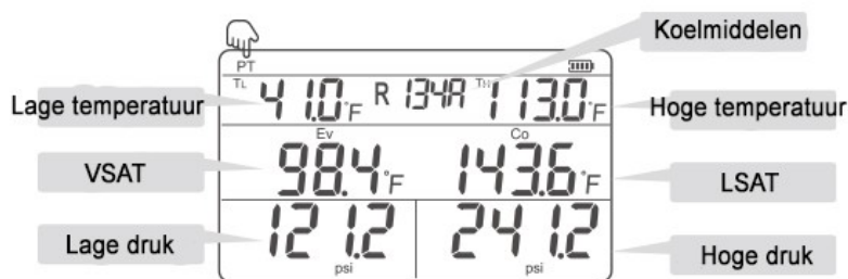
Figuur 1. Schema van de module interface een sub van de verzadigingstemperatuur
