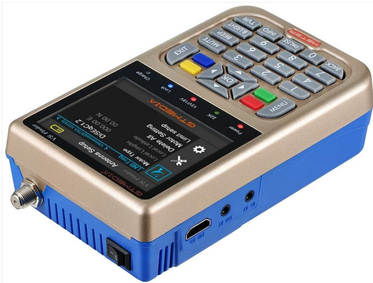
Image 4.2: Side view of the GTMEDIA V8 Finder, highlighting the LNB IN, AV IN, and AV OUT ports.
