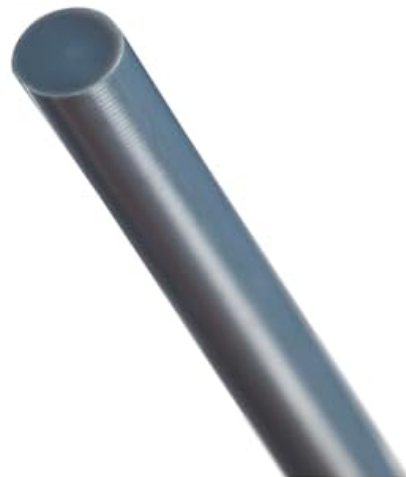
Actual cutting result of ST-A3.0 singe blade nipper ( Real shoot)
