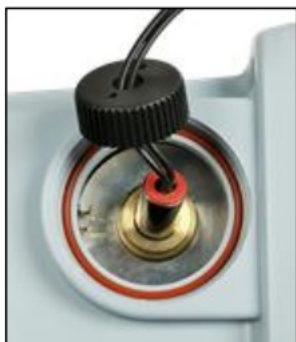
Install the new tungsten filament lamp module.
