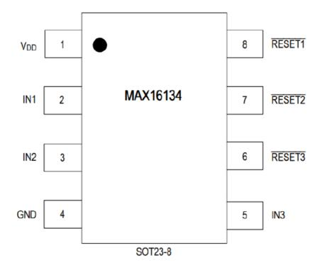
Figure 4-1. MAX16134 Pin Diagram
