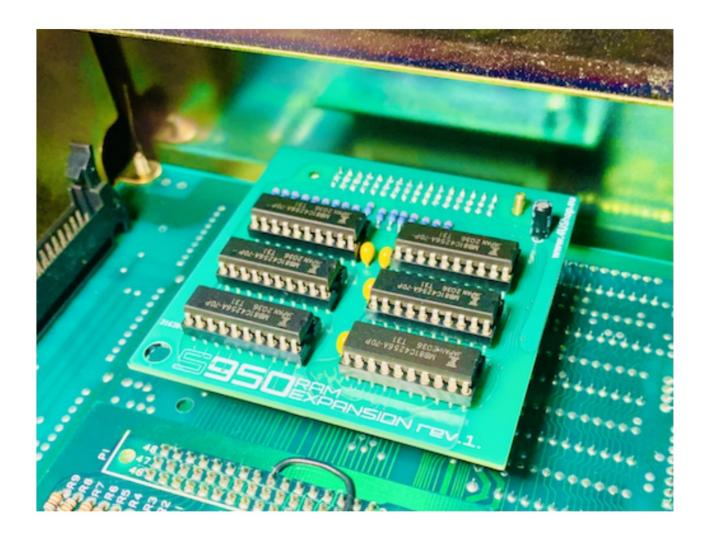
STEP 4 - FIX IT WITH THE PLASTIC WASHER AND M2.5 NUT
