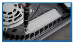
11. REINSTALL THE BACKING PLATE BY SLIDING IT BACK AND PUSHING DOWNWARDS.
